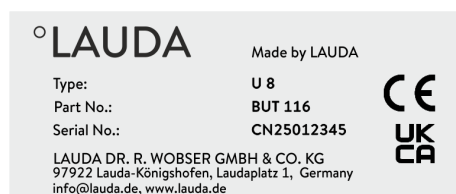
Fig. 12: Placa de características del baño de calefacción
