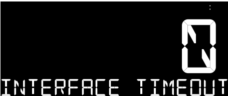
Fig. 24: Supervisión de la conexión desactivada
