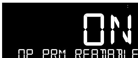
Fig. 31: Lectura de parámetros de funcionamiento habilitada
